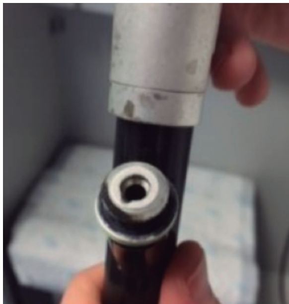
Figura 2. Melladura en la entrada del canal de trabajo del fibrobroncoscopio.
